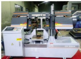
本报记者(记者 曹万里)CH-330HA是全新设计的一款全自动卧式带锯床,它主要用于锯切各种型材,普通黑金属、有色金属及非金属的锯切加工。该锯床采用全新的外观和配色,锯床整体显得大气沉稳,采用触摸屏控制,可输入5组不同的锯切数据,满足客户的多种锯切要求。机床主电机功率为4kw,比普通的机床功率大,锯切强劲,锯切效率高,整根锯架设计加强筋,保证锯切的稳定性。锯床液站为独立外置油箱,电磁阀排放方式由原先的竖立排放更改为横向排放,方便了维修。机床新增快进杆,缩短锯切等待时间。
